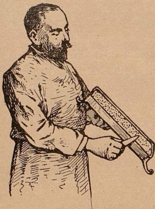
Abb. 84. Beschneiden der Mittelwand am Deckel der Presse
