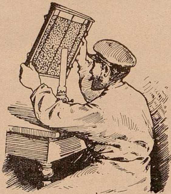
Abb. 92. Einlöten in den Draht
