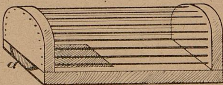
Abb. 56. Weiselhäuschen aus Buchenholz und Draht. a Schieber
