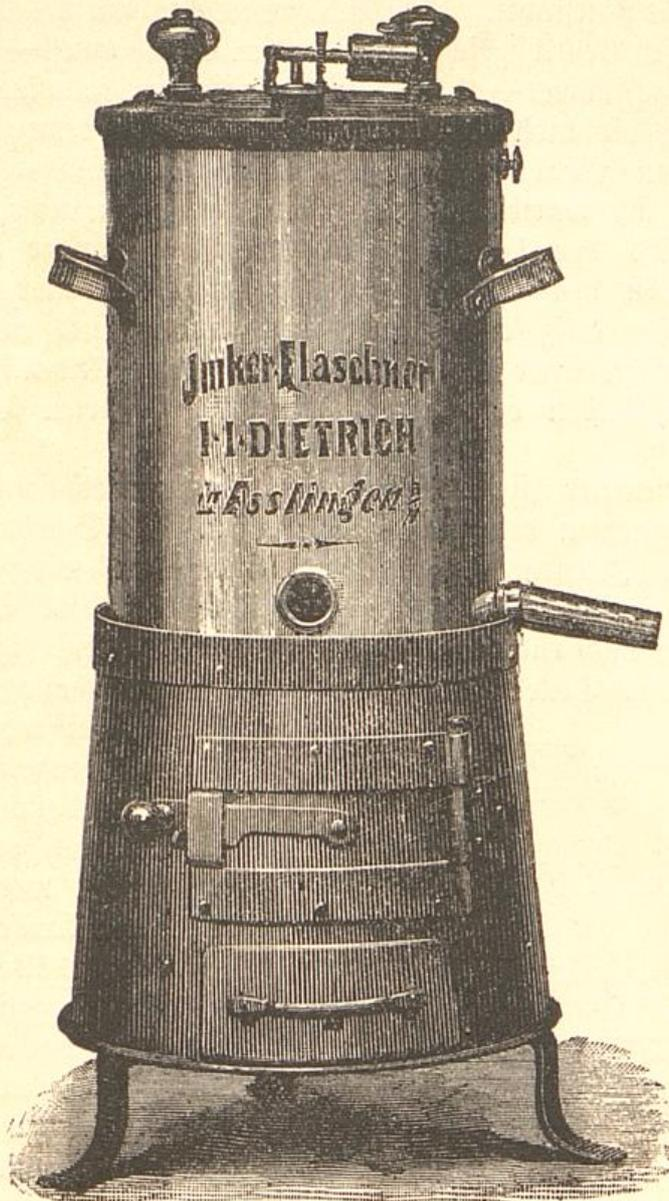
Fig. 24. Honig- und Wachsauflaßapparat mit Dampfwirkung.
